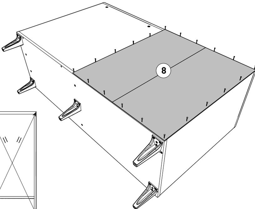
FR- Mesurer les diagonales du meuble pour vérifier l'équerrage. La mesure doit être identique.
