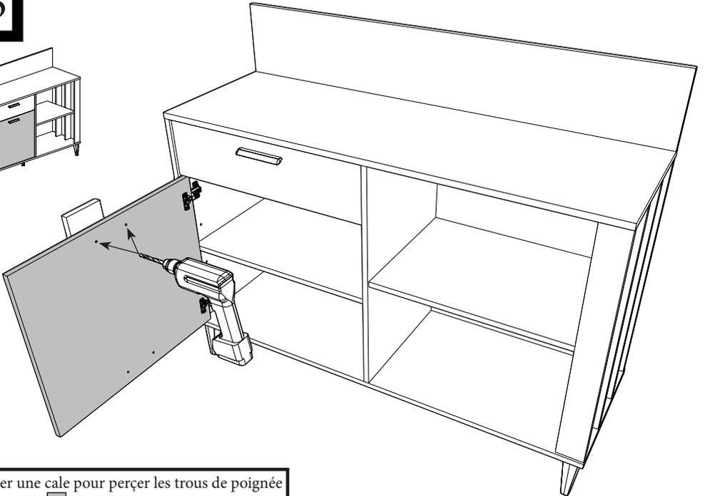
Utiliser une cale pour percer les trous de poignée
