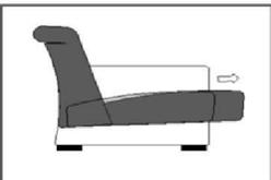
Durch leichten Körperdruck wird die Sitzfläche „stufenlos“ und „individuell bis ca. 12 cm“ nach vorne verschoben. Um wieder in die Standardtiefe zurückzukehren, muss die Sitzfläche jedoch ganz nach vorne geschoben werden, eine Zugfeder unterstützt die Rückwärtsbewegung.
