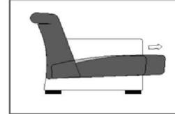
Durch leichten Körperdruck wird die Sitzfläche „stufenlos“ und „individuell bis ca. 12 cm“ nach vorne verschoben. Um wieder in die Standardtiefe zurückzukehren, muss die Sitzfläche jedoch ganz nach vorne geschoben werden, eine Zugfeder unterstützt die Rückwärtsbewegung.
